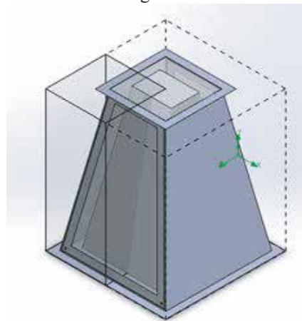
FIGURE 1: SQUARE INCLINED SOLAR CHIMNEY MODEL
